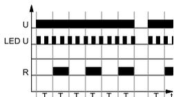
Включение напряжения питания U, начинает отсчёт установленного времени T. После отсчёта времени, наступает срабатывание исполнительного реле R и снова начинается отсчёт времени T. Цикличная работа реле длится до момента выключения напряжения питания U.
